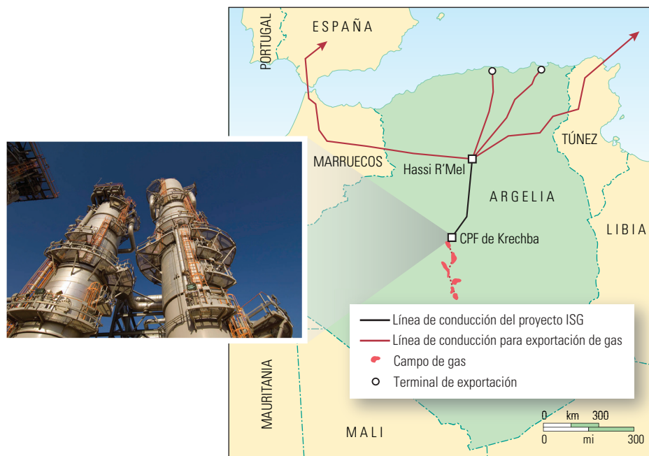
Figura 10. Proyecto In Salah Gas (ISG). El proyecto de almacenamiento de CO 2 In Salah, en Argelia central, consiste en varios campos de gas y una planta central de procesamiento (CPF, inserto ), situada en Krechba, en la que se remueve el CO 2 y otras impurezas del gas natural producido. El gas limpio es enviado por línea de conducción hasta una estación de distribución situada en Hassi R'Mel, Argelia, para su posterior envío a las terminales de exportación y los mercados de Europa.
