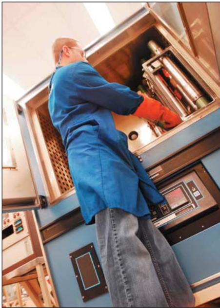
^ Equipo de recombinación de muestras del centro SRFC para obtener muestras de fluidos representativas a partir de los fluidos extraídos en boca de pozo.
