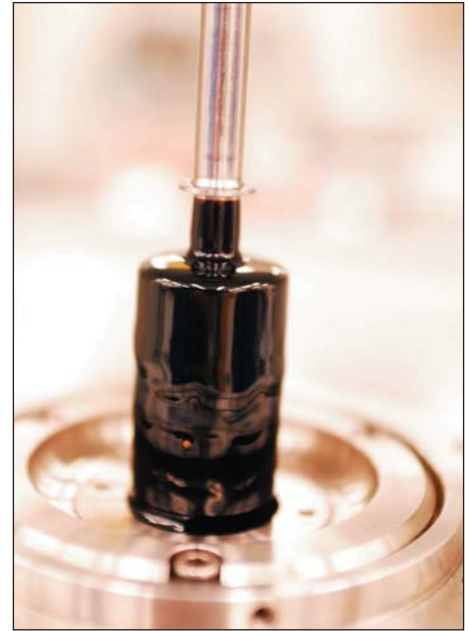
^ Medición de la viscosidad del petróleo viscoso con un reómetro. Los reómetros miden los cambios producidos en la viscosidad con la variación de la tasa de flujo. Esto es importante para la caracterización de los petróleos viscosos que exhiben un comportamiento no Newtoniano, lo que significa que su viscosidad es una función del índice de cizalladura (corte).
