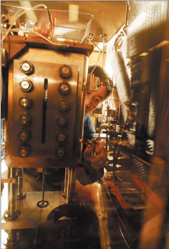
^ Dispositivo de análisis PVT del centro SRFC, utilizado para medir la presión de burbuja mediante la despresurización de una muestra en una prueba de expansión a composición constante (CCE). El punto de burbuja es la presión a la que el volumen de la muestra aumenta significativamente. Una prueba CCE que mezcla la muestra de petróleo pesado arroja un punto de burbuja que se ajusta a los cálculos ideales, mientras que el método CCE tradicional produce un punto de burbuja que es demasiado bajo.
