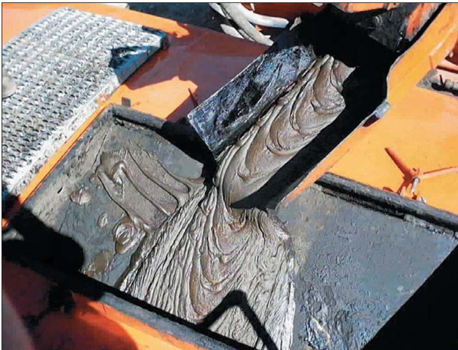
^ Lechada producida por el método de producción de petróleo pesado en frío con arena (CHOPS). Esta muestra de fondo de tanque fue recuperada en una playa de tanques de una unidad de limpieza de petróleo cercana a Lloydminster, Saskatchewan, Canadá, y se compone de aproximadamente 10 a 20% de arcilla fina y sílice, 20 a 30% de petróleo viscoso y 50 a 60% de agua. (Fotografía, cortesía de Maurice Dusseault).
