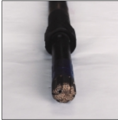
▲Cabeza fresadora Bridge Blaster. El sistema Bridge Blaster se puede configurar con una cabeza expulsora radial, un anillo flotante y una fresa Reed-Hycalog (izquierda), o bien con boquillas de chorro abrasivo orientadas hacia abajo (derecha), que perforan un hoyo en los puentes de incrustaciones que no se pueden cortar con una fresa de carburo de tungsteno.
