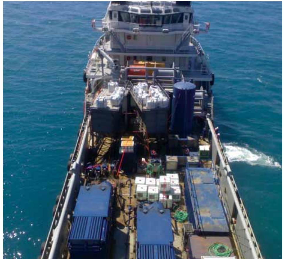
Embarcación de abastecimiento modificada que utiliza equipos de fracturamiento de tierra firme con el fin de estimular un pozo del Mar Negro para Petrom S.A.
